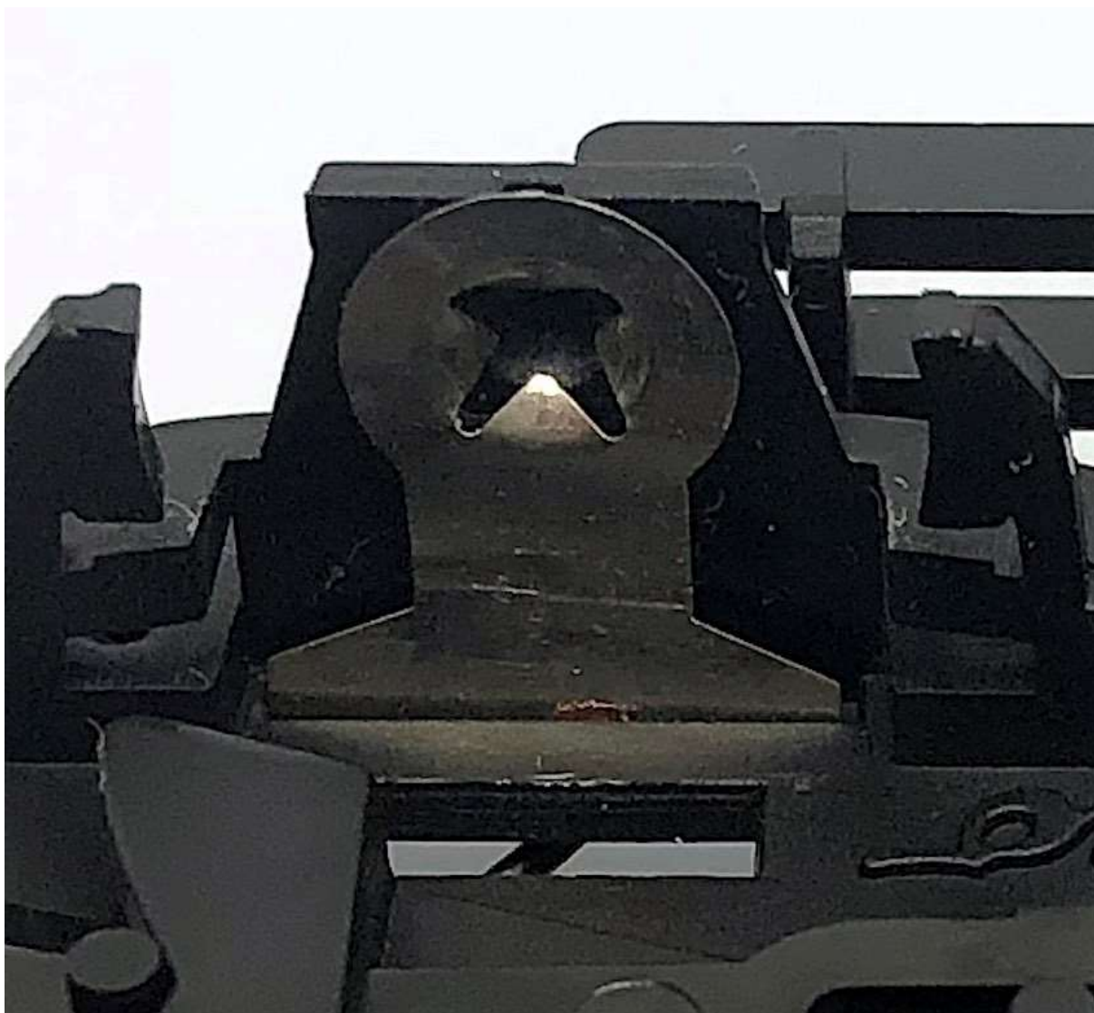
Rys. 1 Oryginalna blaszka odbioru prądu – podczas wykonywania wystarczy dociąć dopasowany trapez
